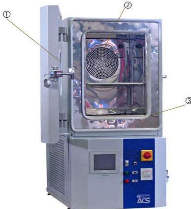
1. **Beheiztes Sichtfenster:** Eine vollkommen durchsichtige Heizfolie gestattet uneingeschränkte Einsicht in den Prüfraum und verhindert die Bildung von Kondensat auf dem Glas. Die Abmessungen des Sichtfensters beträgt 230 mm x 230 mm.
