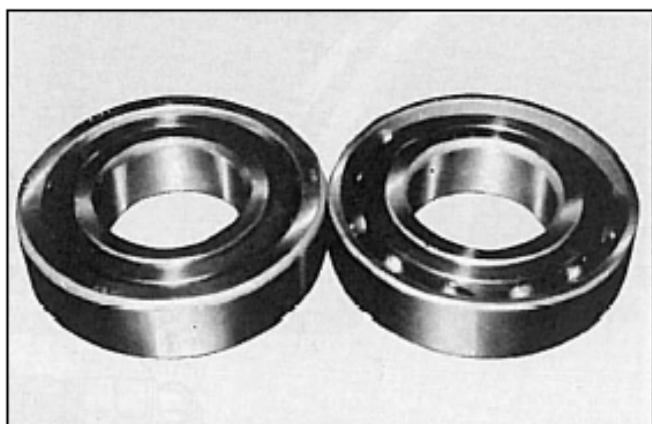
Fig. 47 Paire de palier de butée (palier gauche positionné sur celui de droite lors du montage)
