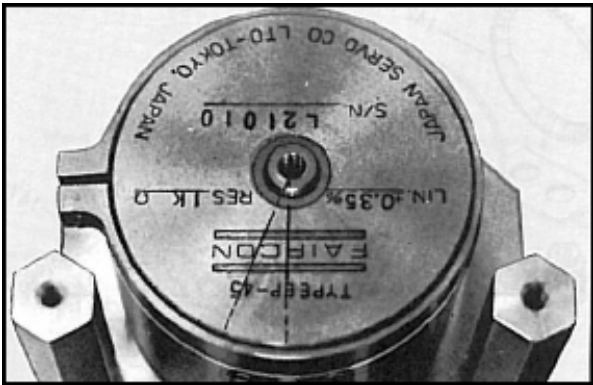
Fig. 151 Ajustage du potentiomètre en charge nulle
